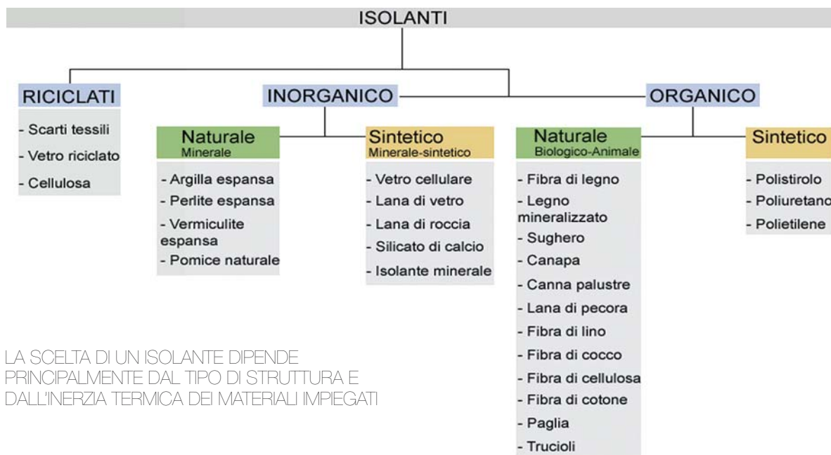
Fig. 1 > Catalogazione dei materiali isolanti dal punto di vista chimico
